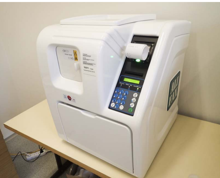
Automatizovaný systém TEST 1 (patent firmy ALIFAX) ke zpracování požadavků na sedimentaci erythrocytů
